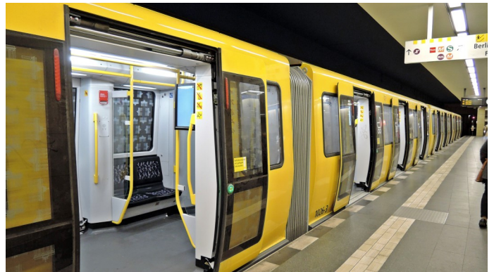
Von außen ist „ der Bauch “ (die Bombierung) gut zu erkennen. Ein IK besteht aus 4 durchgängigen Wagen.
