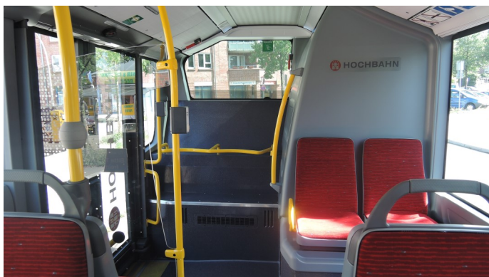
Das Fahrzeug ist für die Linie 5 optimal mit seinen fünf über die 21m Fahrzeuglänge verteilten Türen.
