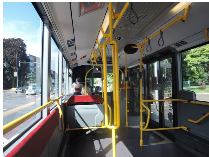
Im Wageninneren ist zwischen der zweiten und dritten Tür ein zweiter Mehrzweckbereich vorhanden.
